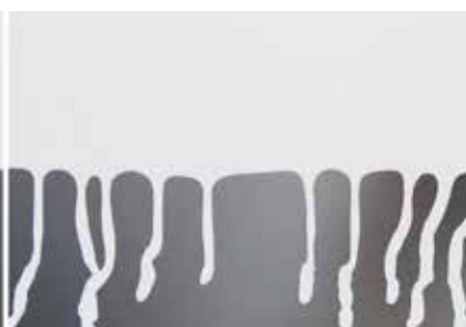
一般エポキシ塗料 膜厚: 50μm
